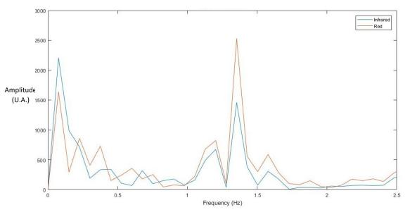
Le calcul de la SpO<sub>2</sub> et du BPM s'effectue grâce programme sous Matlab segmenté en plusieurs parties (a.). Dans un premier temps les signaux sont acquis via une carte Arduino, puis fragmentés en échantillon de 10s environ. Cette durée permet d'avoir à la fois un temps suffisant et à la fois pas trop long pour éviter les variations importantes de BPM. L'ajustement l'échantillonnage sert à ne pas suréchantillonner, ce conduirait à une transformée
