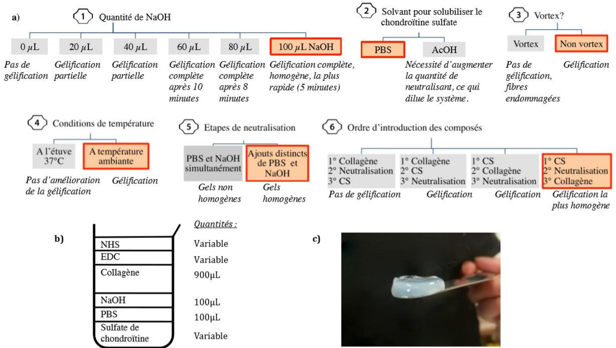
**Figure 1. Conditions expérimentales pour la création d'hydrogels de collagène I et d'hydrogels composites collagène I / sulfate de chondroïtine (CS).**
