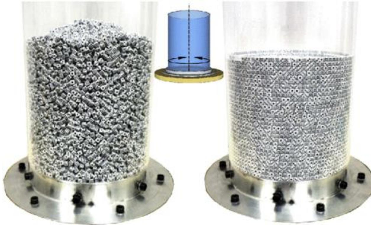
Le but est ce projet est de trouver des techniques de compaction de milieu granulaires en fonction de la forme des grains. On réalisera une expérience avec des dés (cf. figure) pour commencer.
