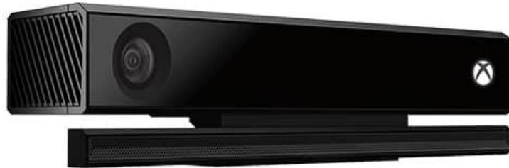
La Kinect est une caméra de temps de vol très performante qui permet de mesurer la vitesse de la lumière (et de faire de l'imagerie 3D). Le but de ce projet est de l'utiliser pour réaliser des expériences historiques de Foucault mais aussi des mesures de durée de photon vie en cavité, de principe de Fermat ou de détection dans les milieux diffusants
