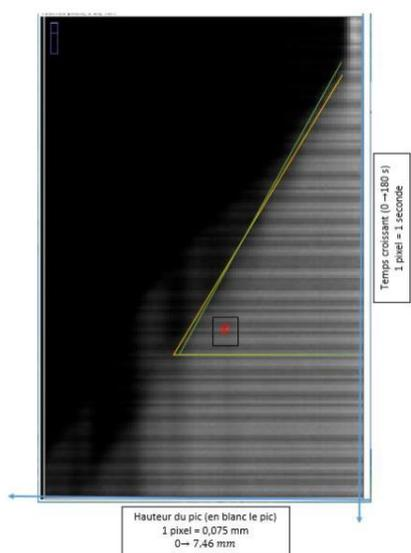
Que l'on peut traiter en sachant qu' en abscisse on a le temps et en ordonnée la distance. On peut alors accéder à la vitesse de croissance de notre échantillon en réalisant le calcul suivant :
