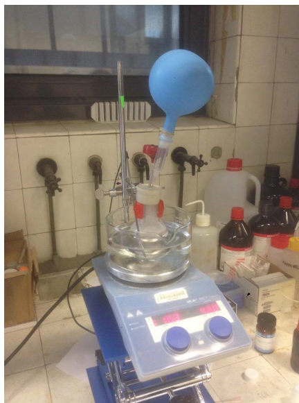
FIGURE 1.1 – Montage de réaction sous atmosphère inerte
