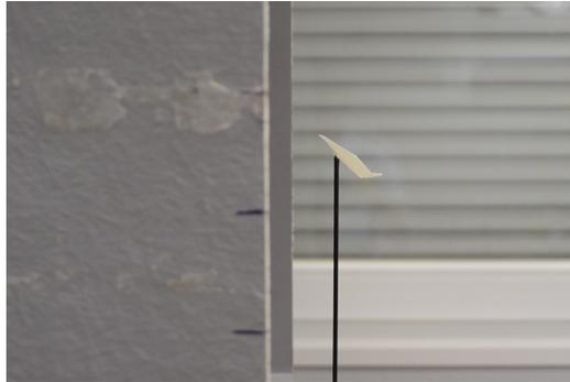
Figure 2: Avion en position sur la tige de la balance aérodynamique
