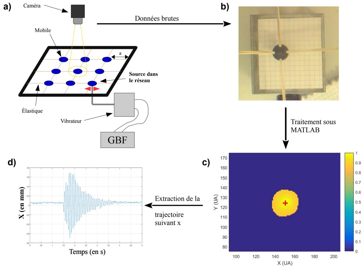
FIGURE 1 – Protocole d'acquisition de la trajectoire d'un mobile
