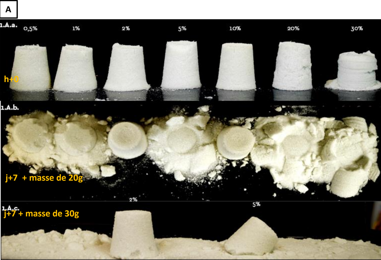
A. Mélange monodisperse A.a. Formation de tours ( h=41\text{mm} , \phi_{\text{sommet}} = 28\text{mm} ) de billes de verre ( \phi=0,15-0,25\text{mm} ) avec des proportions en eau croissante : 0,5%, 1%, 2%, 5%, 10%, 20% et 30% en masse respectivement; vue de profil. A.b. Observations près avoir posé une masse constante de 20g sur chaque tour, seules les tours de 2%, 5% et 10% en eau restent debout; vue de dessus. A.c. Observations avec une masse de 30g sur chaque tour, seule la tour de 2% reste quasi-intacte.
