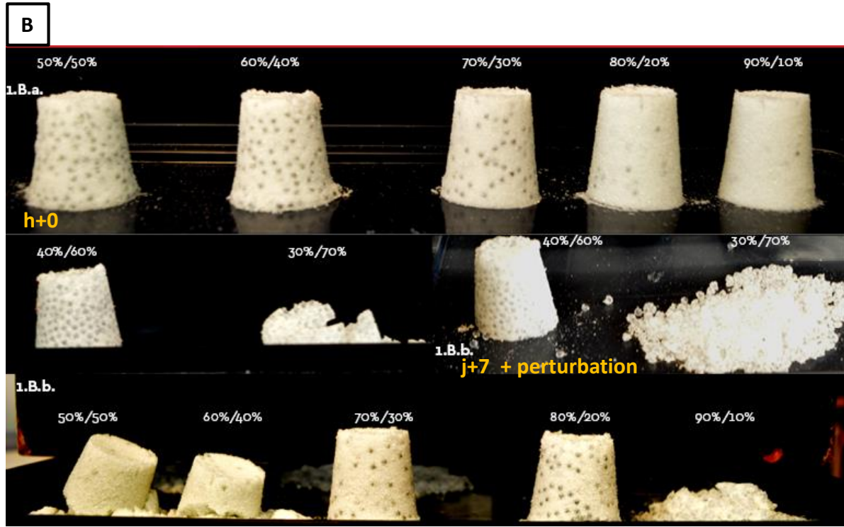
Figure 1 : Étude qualitative de la solidité de tours de billes de verre en fonction de la quantité d'eau ajoutée et de la polydispersité (appareil Nikon D3200)
