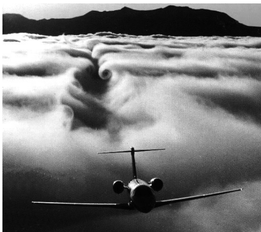
Figure 6 : Avion Cessna Citation en montée à 300 km/h au-dessus d'une couche de nuages. (Extrait de Gallery of Fluid Motion Phys. Fluids A , 5 septembre 1993).
