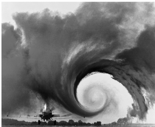
Figure 7 : Visualisation, par injection de fumée près du sol, du vortex de bout d'aile d'un avion de pulvérisation de produits agricoles (document NASA).
