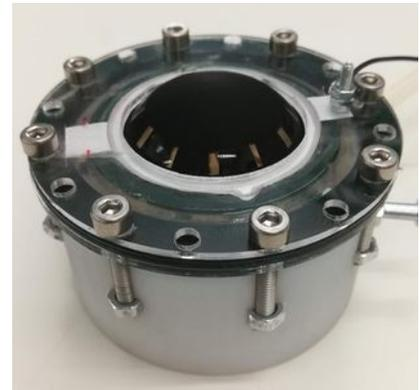
*Figure 1: Prototype de haut-parleur diélectrique*
