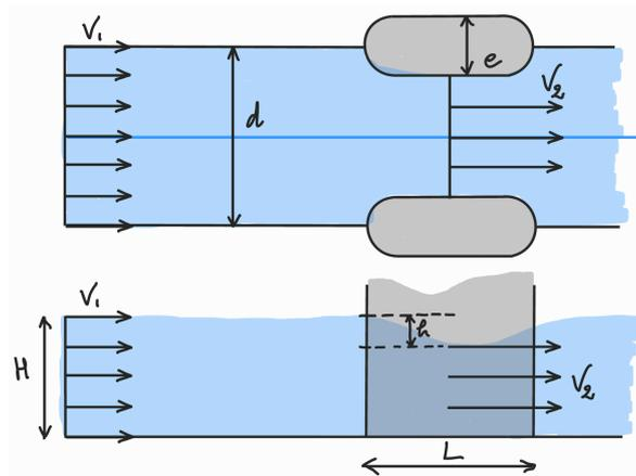
Figure 5: Écoulement entre les piles d'un pont. **En haut:** vue de dessus, **En bas:** vue de côté.
