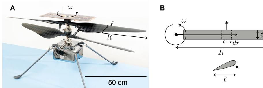
Figure 4: A. Schéma du drone Ingenuity (image NASA). B. Version simplifiée d'un pale d'hélice, vue du dessus et en coupe.
