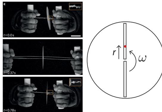
Figure 2: Schéma de principe de l'expérience : un disque pourvu de deux canaux radiaux est entraîné en rotation rapide par un simple système mécanique, ce qui permet de centrifuger du sang avec un équipement modeste.
