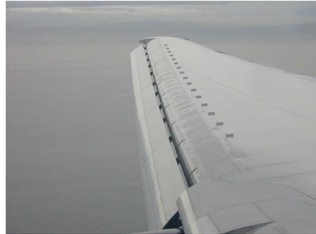
Figure 8: Schéma d'un profil d'aile avec bec de bord d'attaque et volets de bord de fuite. Document NASA. A droite, volet de bord de fuite et générateurs de turbulence sur une aile de Boeing 767.
