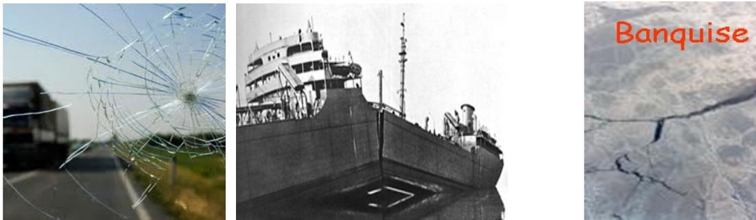
**Figure 1** : Légende des photos, de gauche à droite, Impact sur un pare-brise, rupture des ponts et des coques des bateaux 'liberty ships' et fissuration de la banquise.
