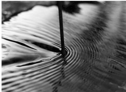
7. Lorsqu'on place un obstacle dans un écoulement, on observe des ondes de petite longueur d'onde en amont et des ondes de grande longueur d'onde en aval (comme sur l'image ci-dessus). Pourquoi ?
