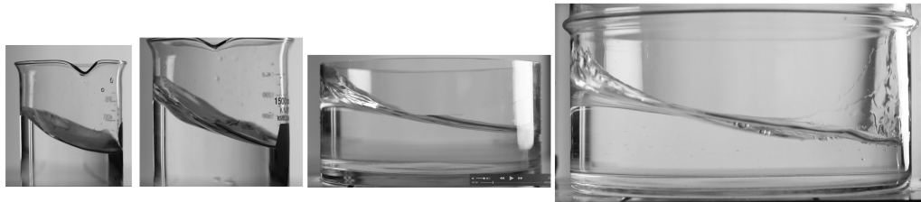
FIGURE 1 – Vagues dans des récipients cylindriques de diamètre 8,7 cm, 11,5 cm, 19 cm et 29 cm
