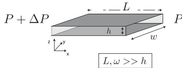
Soit un conduit rectangulaire de longueur  $L$ , et de dimensions perpendiculaires à l'écoulement  $w$  et  $h$ , rempli d'un fluide de viscosité  $\eta$ . On impose une surpression  $\Delta P$  pour mettre le fluide en mouvement. En régime stationnaire, on obtient un débit constant  $Q$ , que nous allons essayer de déterminer et de relier aux grandeurs impliquées.
