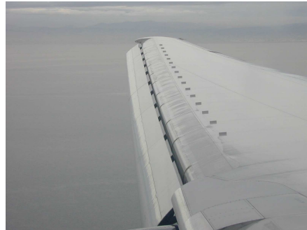
FIG. 7.7 – Schéma d'un profil d'aile avec bec de bord d'attaque et volets de bord de fuite. Document NASA. A droite, volet de bord de fuite et générateurs de turbulence sur une aile de Boeing 767.
