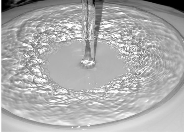
FIG. 4.3 – Ressaut hydraulique circulaire formé sur une surface plane à partir du jet d'un robinet
