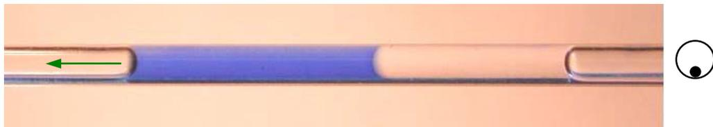
Figure VI.3 : Couple eau savonneuse / huile silicone dans un capillaire de  $600 \mu\text{m}$  de rayon doté d'une fibre colorée de  $100 \mu\text{m}$  de rayon.
