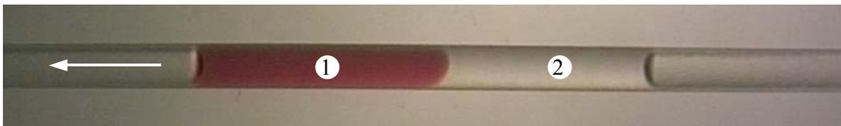
*Figure III.11 : Ménisque inversé : système éthanol / huile silicone dans un tube en polyéthylène (la bigoutte se déplace spontanément dans le sens indiqué par la flèche).*
