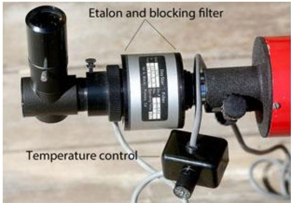
Filtre H $\alpha$  monté sur un télescope (Daystar)
