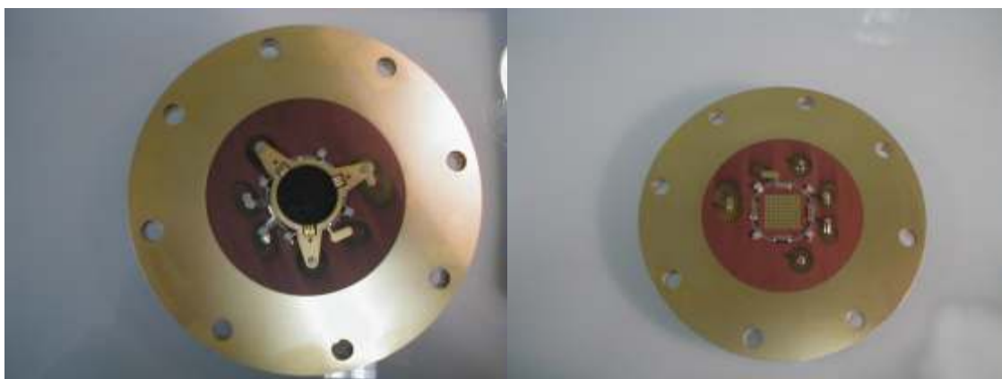
Figure V-13 : détecteurs MCP à gauche (diamètre utile 27mm) et réseau de 64 anodes (2.18 x 2.18 mm 2 ) à droite.
