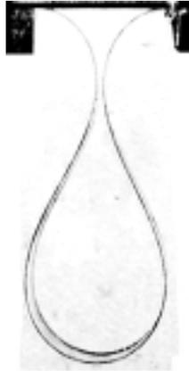
**Fig. 2.13** – *Photo de plis libres les plus courbés. Si l'on augmente encore l'excès de surface, un contact entre les deux branches apparaît, ce qui exige une modélisation différente.*
