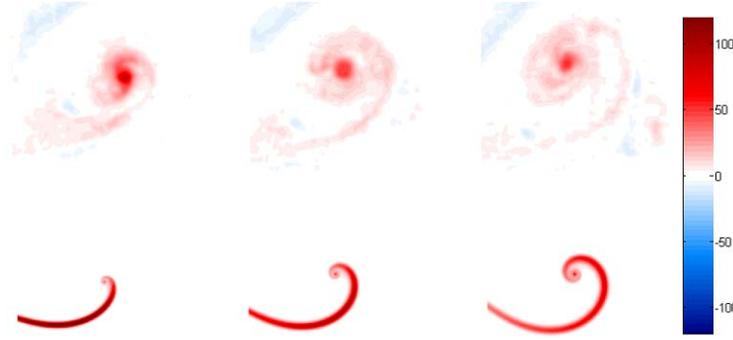
Figure 3.5: Comparaison des champs de vorticit  (a) mesur s par PIV dans l'exp rience et (b) issus du calcul num rique d'une spirale unique dans le mod le de Lundgren (les d tails sont dans [34], report  dans l'annexe C).
